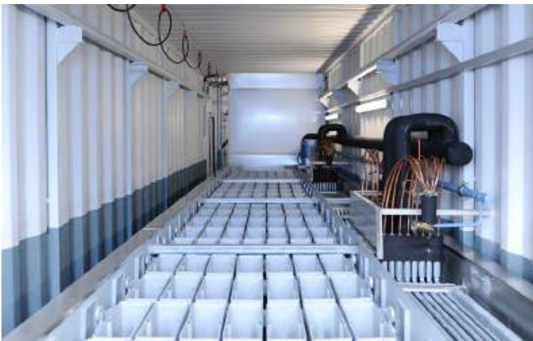
Impianto per ghiaccio in blocchi, installato all'interno di un container
